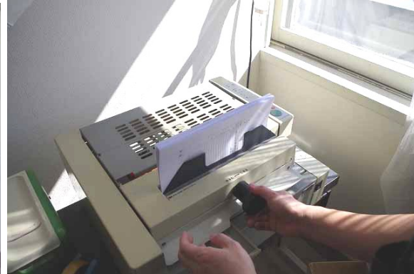
ジャジャーン 出ましたホリゾン社製綴じ機 原稿をセット
